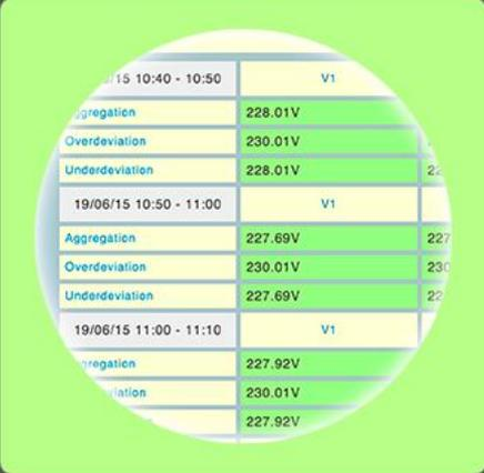
Esta aplicación permite generar un informe sobre el Historial gráfico de tensión diezminutal. Podrá exportar a pdf, excel, doc o xml la sobredesviación y subdesviación de V1, V2 y V3 de multitud de equipos.
