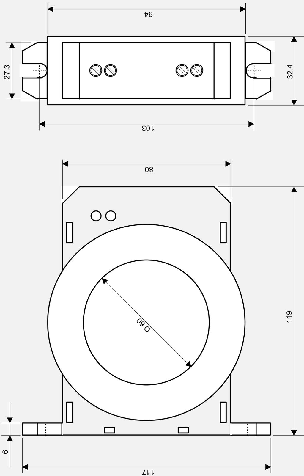
DIMENSIONES TRANSFORMADOR TOROIDAL: TRDF60
