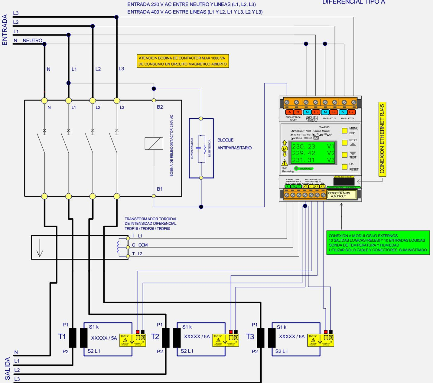
ATENCION BOBINA DE CONTACTOR MAX 1000 VA DE CONSUMO EN CIRCUITO MAGNETICO ABIERTO
