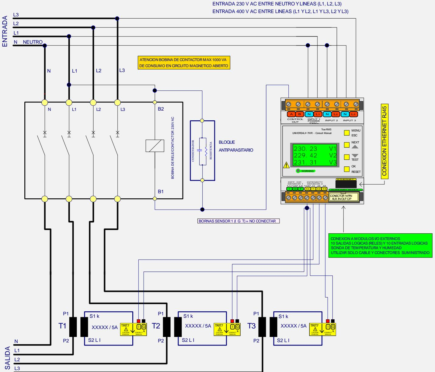
T1, T2 Y T3 TRANSFORMADOR TOROIDAL DE INTENSIDAD DE LINEA
