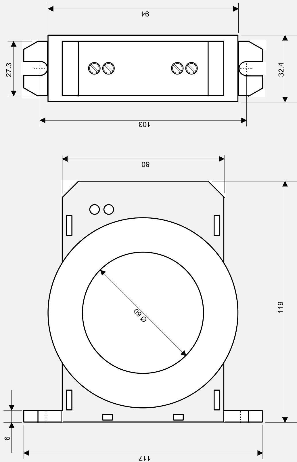
DIMENSIONES TRANSFORMADOR TOROIDAL: TRDF60
