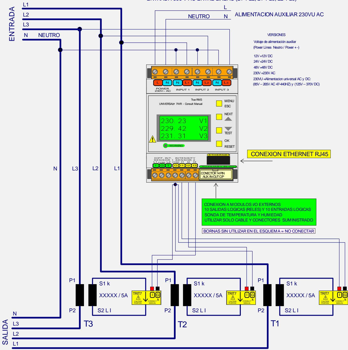
T1, T2 Y T3 TRANSFORMADOR TOROIDAL DE INTENSIDAD DE LINEA
