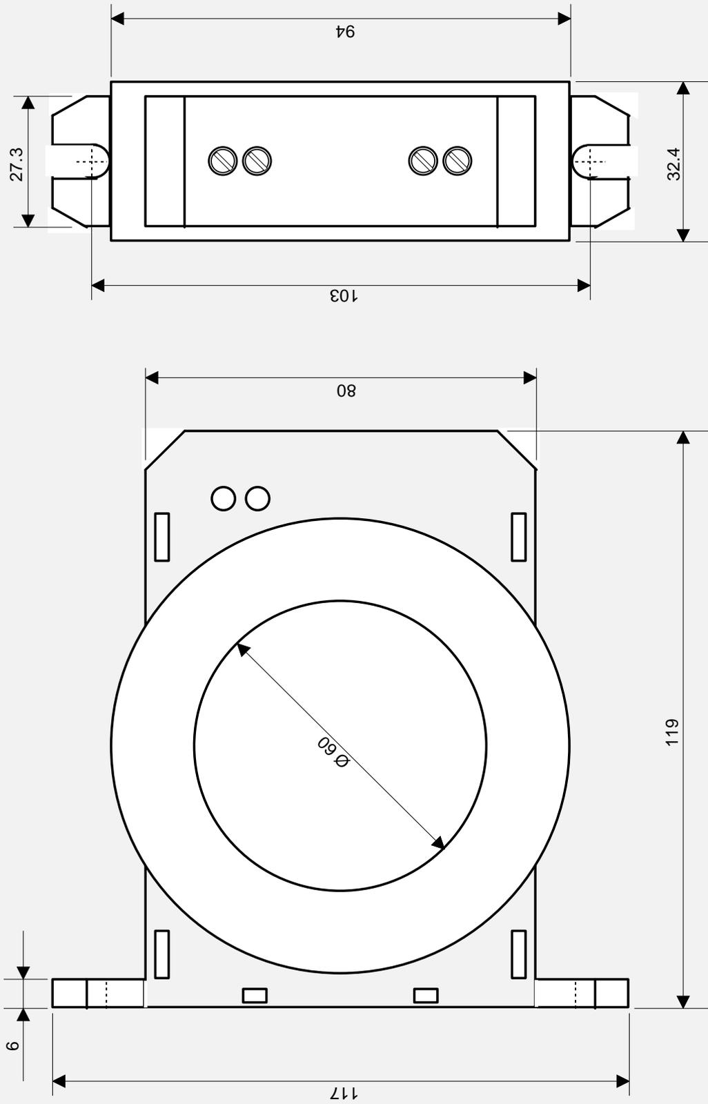
DIMENSIONES TRANSFORMADOR TOROIDAL: TRDF60
